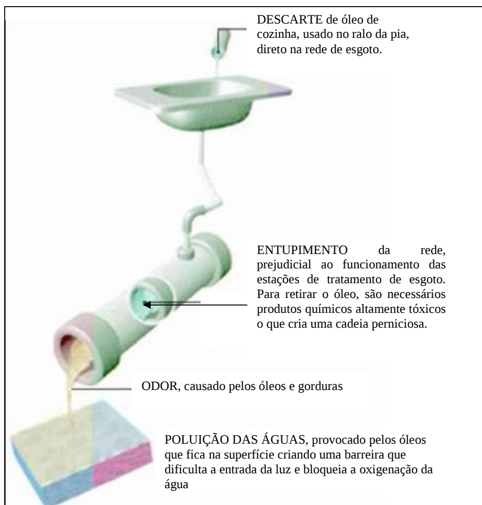
Figura 3: Processo de saponificação da gordura na tubulação após seu lançamento na pia. Fonte: DIÁRIO DE NATAL (2007).
